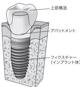
図2 インプラントの基本構造
